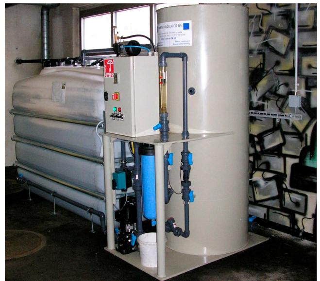
FBR-EasySwiss Anlage mit 3000 Liter Arbeitsbehälter: Durchsatz max. 2 m<sup>3</sup> pro Tag
