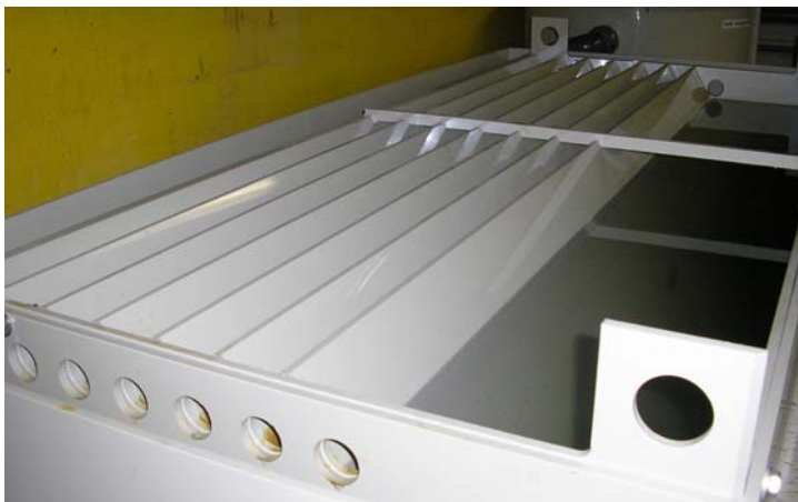
Décanteur lamellaire compact prévu pour traiter 1 \text{ m}^3 par heure.
