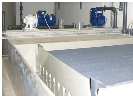
Cuve compacte réacteur 1 + réacteur 2 + décanteur lamellaire, capacité jusqu'à 3 \text{ m}^3 par heure
